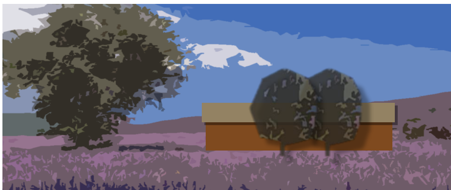
La plantation d'un bouquet d'arbres ou seulement d'un arbre brise la longueur du bâtiment et en diminue l'impact visuel
